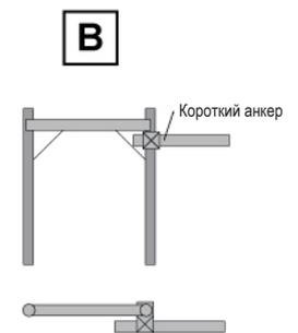
Короткий анкер, прикрепленный к внешнему стояку рамы, который обеспечивает перенесение на стену только перпендикулярных нагрузок.
